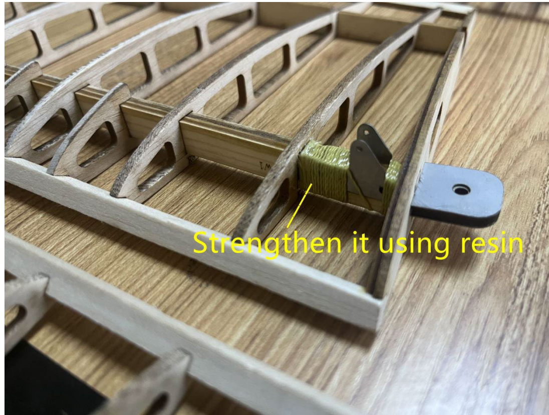
Schritt 38: Holmkasten mit Kevlar und Epoxidharz verstärken.
