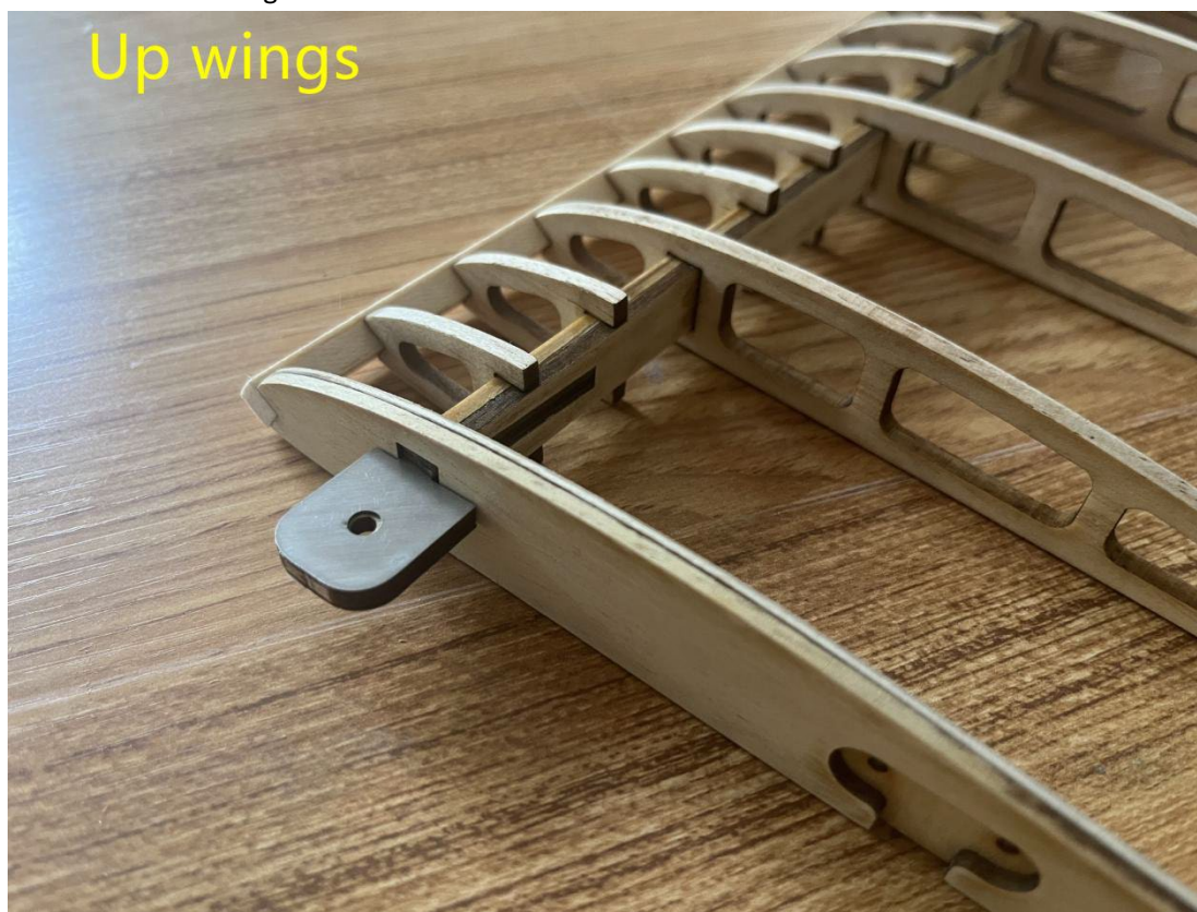
Schritt 30: Obere Tragfläche.
