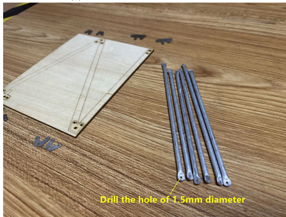
Schritt 16: Loch bohren, 1,5 mm Durchmesser.
