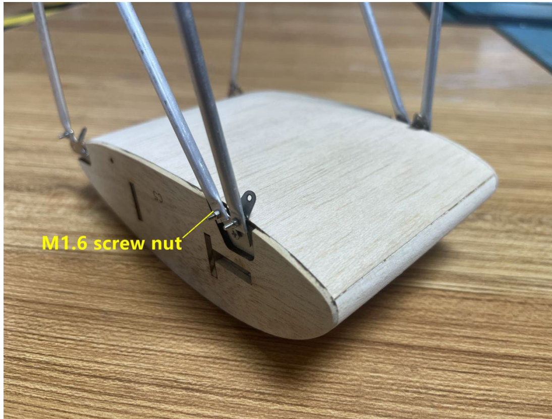
Schritt 20: Aluminium Röhrchen, 3 mm Durchmesser.
