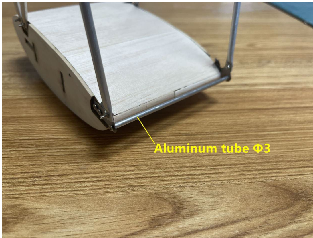
Schritt 20: Aluminium Röhrchen, 3 mm Durchmesser.
