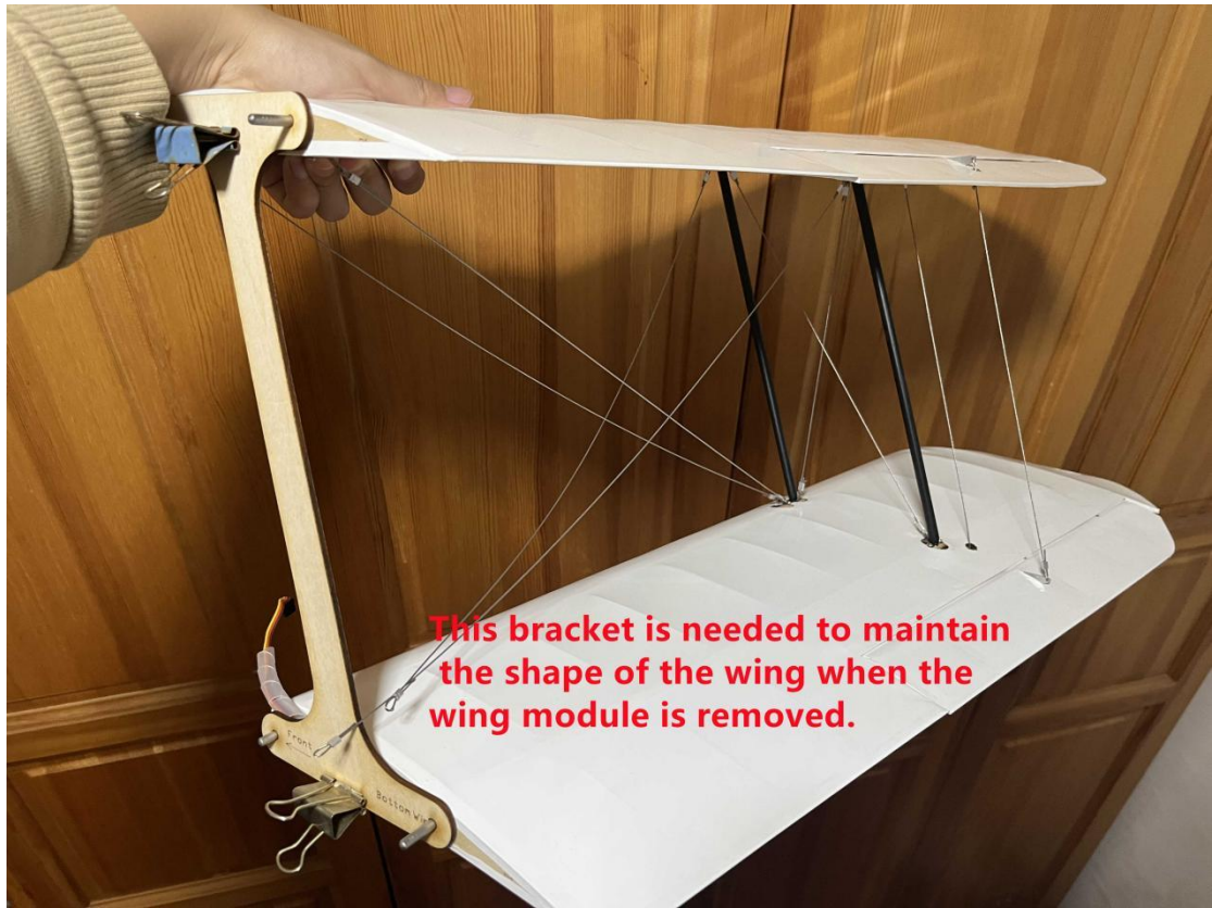
1 Diese Montagelehre verhindert ein Verziehen der Tragflächenbaugruppe nach der Demontage.
